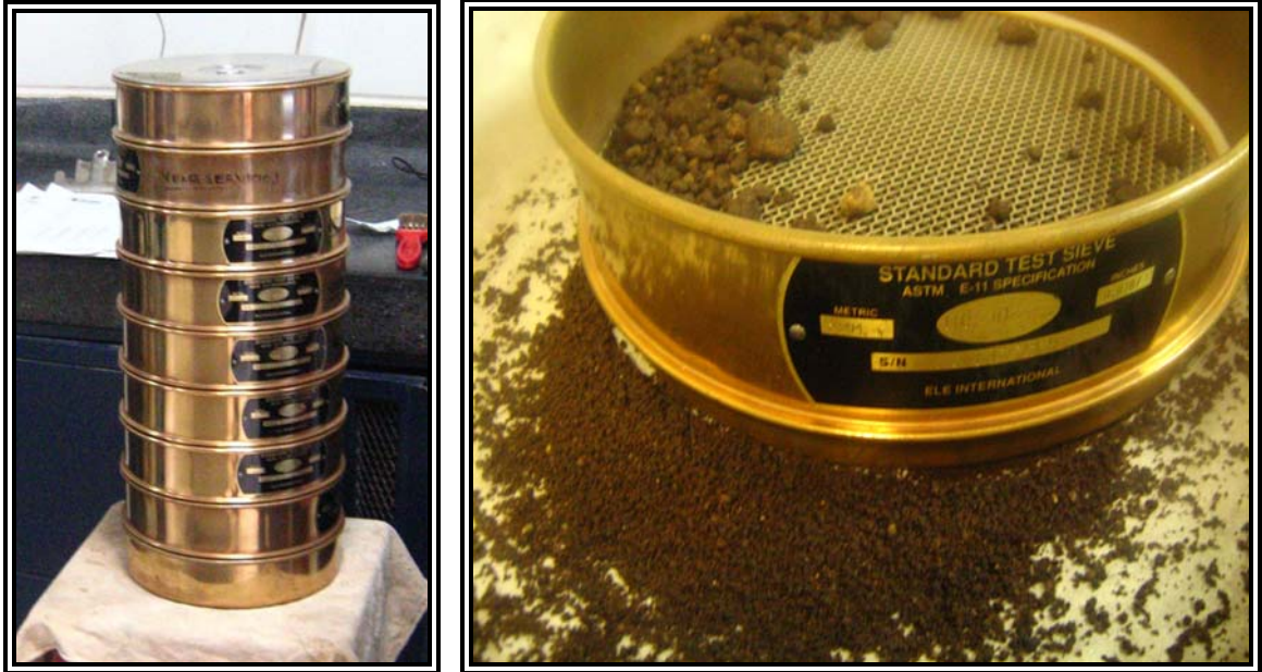
Figura 16. Tamizado de suelos.
