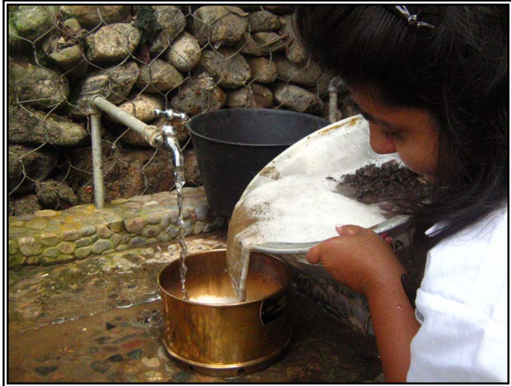
Figura 15. Lavado de suelos contaminados, para granulometría.
