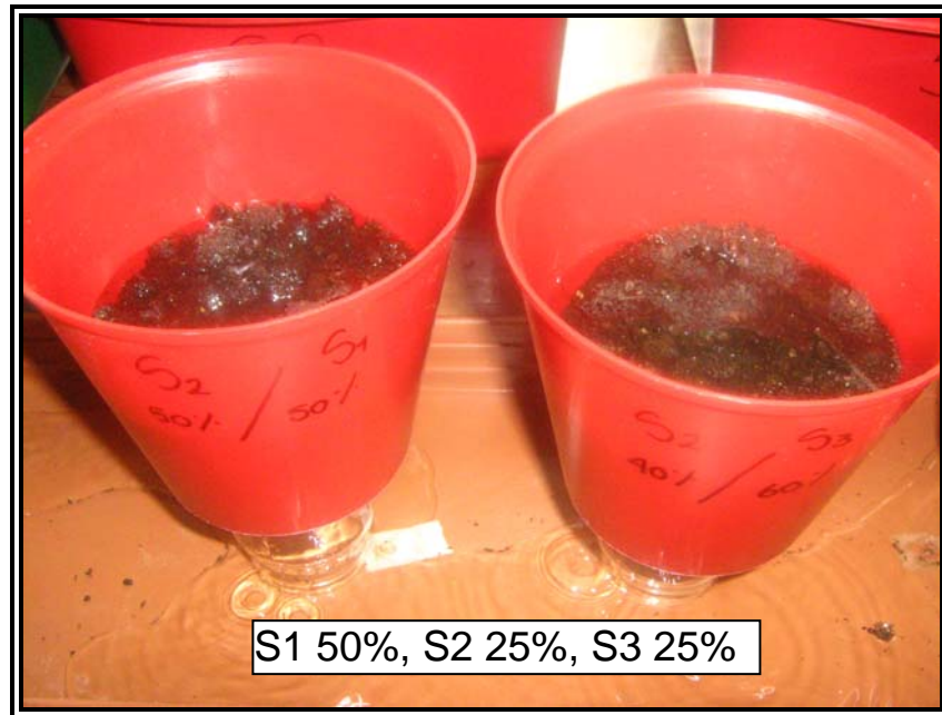
Figura 14. Prueba de capacidad de campo.
