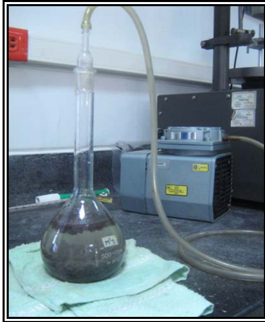
Figura 18. Determinación de la densidad real.
