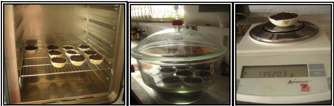
Figura 13. Determinación de la humedad gravimétrica.
