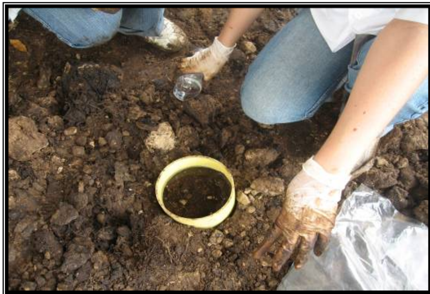
Figura 12. Pruebas de permeabilidad e infiltración.
