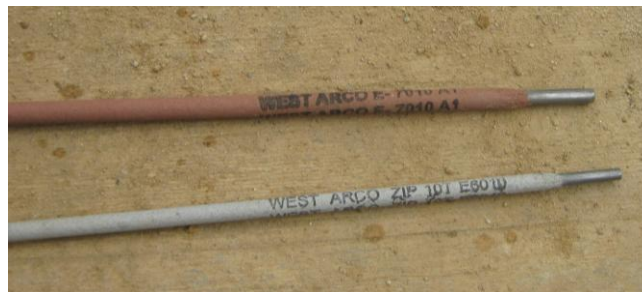
FIGURA 18: Electrodos para paso de raiz y pases de relleno.
