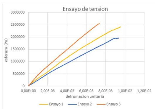
Figura 3. Curva de ensayo de tensión. Fuente: Elaboración propia.
