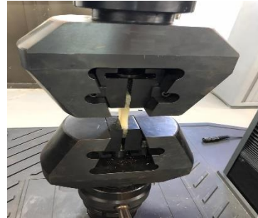
Imagen 05. Ensayo de tensión
