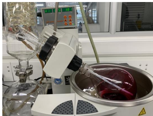
Figura 1. Imagen de proceso de rotoevaporador del extracto de agraz
