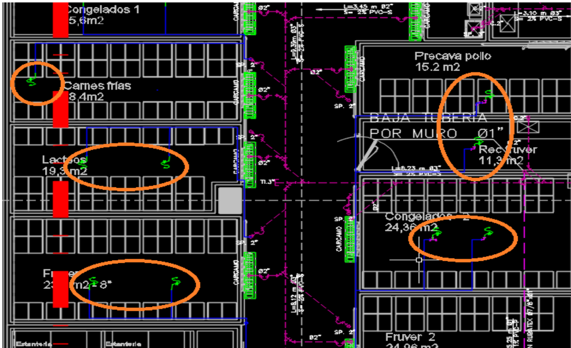
Figura 5: Actualización de red desagües de aires acondicionados Alkosto.
