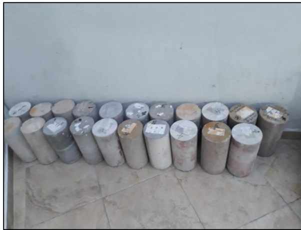
Imagen 26 Cilindros testigos de las diferentes obras realizadas
