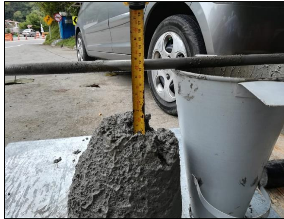
Imagen 28 Revisión de diseño del concreto y prueba de asentamiento
