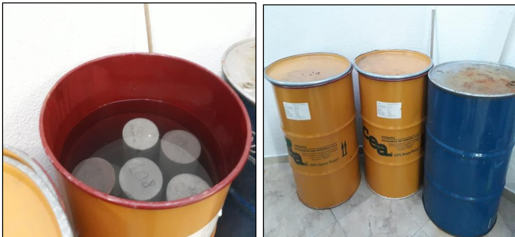
Imagen 27 Tanques de curado de cilindros
