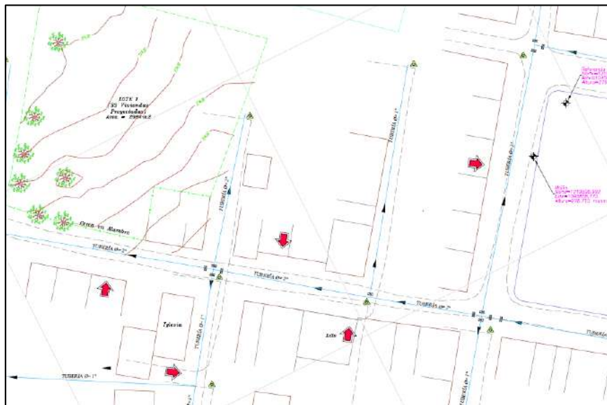
Ilustración 22. Red Primaria, Secundaria y Válvulas - Corregimiento Santo Domingo Fuente: Alcaldía Municipal - El Carmen de Chucurí
