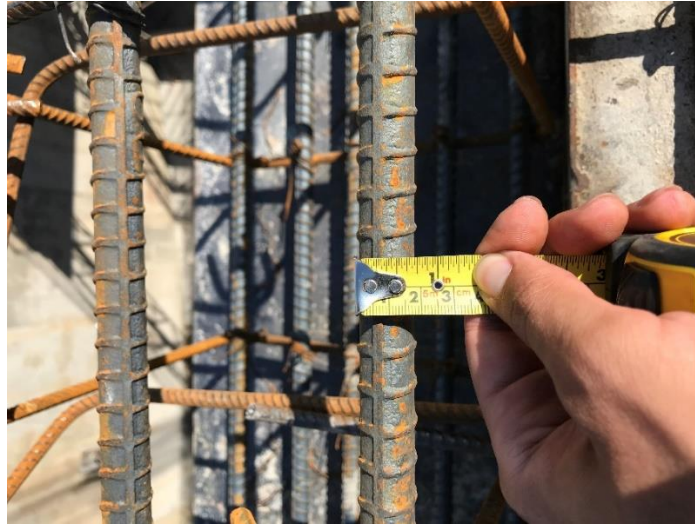
Foto 36. Medida de diámetros de las varillas
