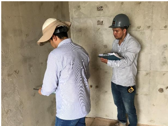
Foto 29. Ensayo de esclerometría
