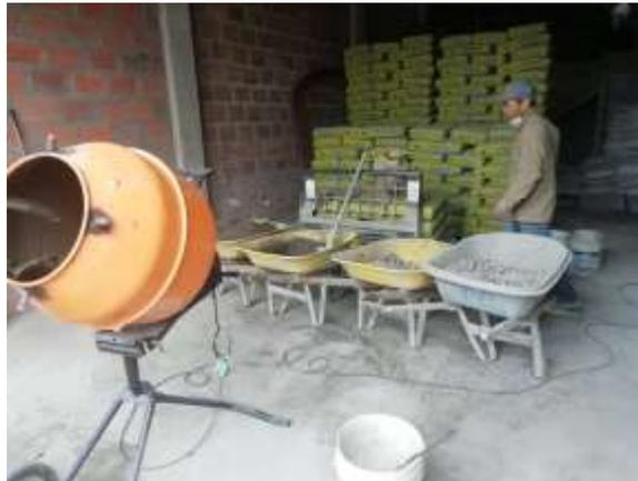
*Ilustración 12. Preparación de materia prima para prueba de concreto.*
