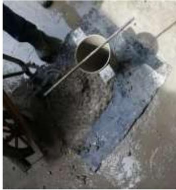
*Ilustración 9. Ensayo de Slump*
