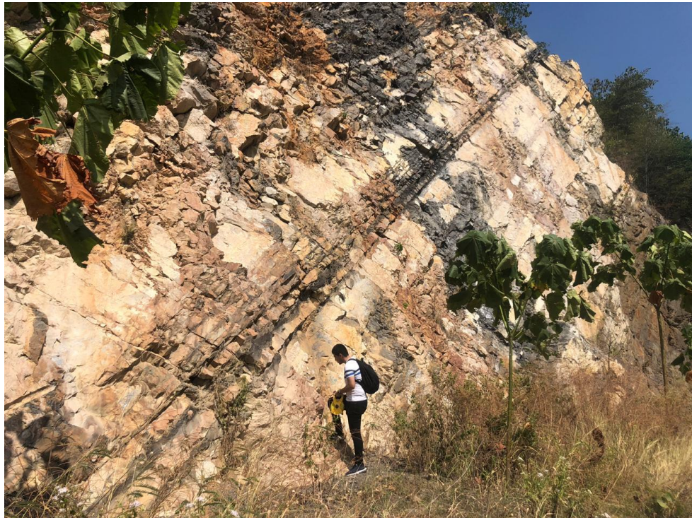
Figura 11. Detalle del cambio de tonos del macizo rocoso asociado a proceso de oxidación
