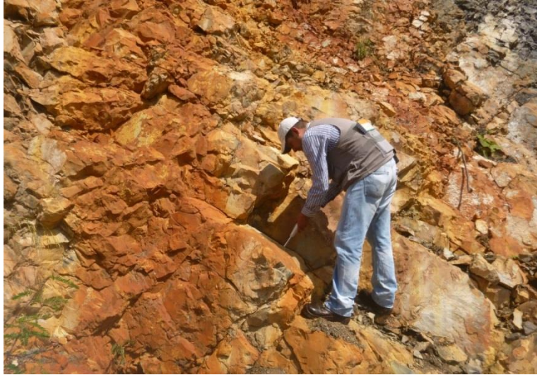
Figura 18. Toma de datos con el martillo Schmidt.
