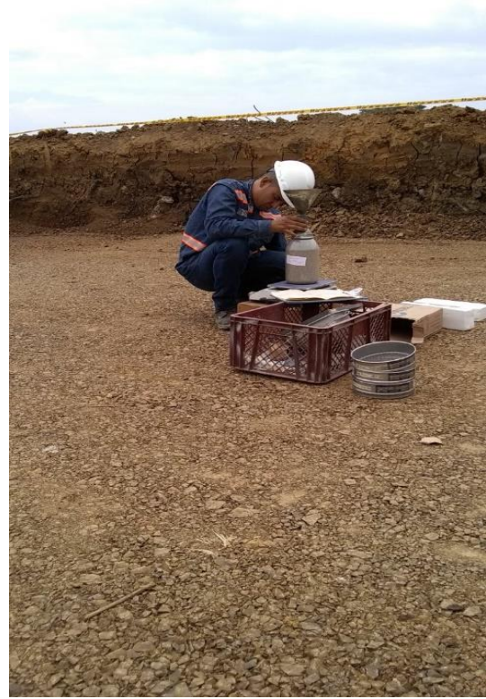
Imagen 48. Densidad con cono de arena Imagen 49. Ubicación 4 puntos aleatorios
