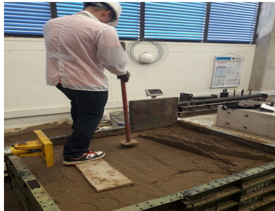
Figura 20 Compactación de suelo de fundación
