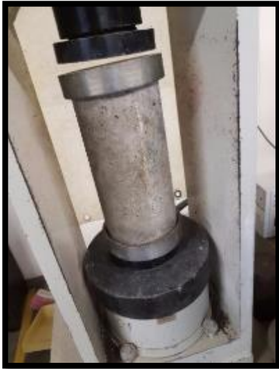
Ensayo de compresión del concreto.
