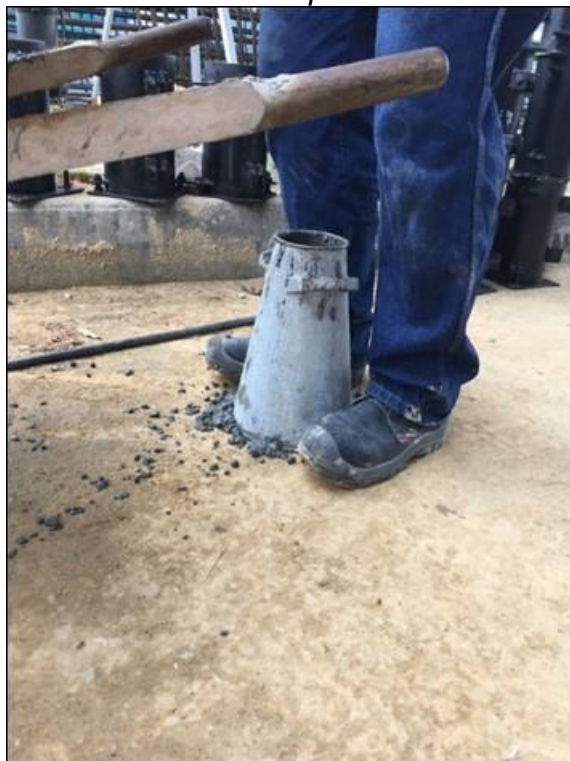
Fotografía 15. Toma de muestra, Slump.
