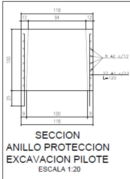
Esquema 2. Anillo protección excavación pilote.
