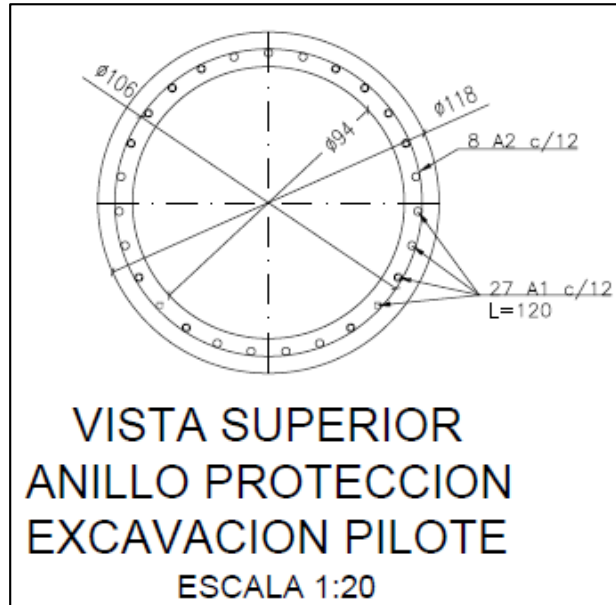
Esquema 11. Vista planta Anillo protección Pilote.
