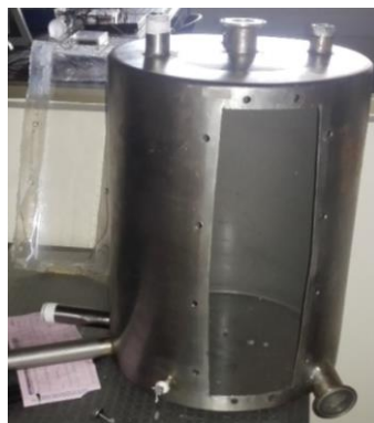
Figura 34. Tanque dos explotado desmontado
