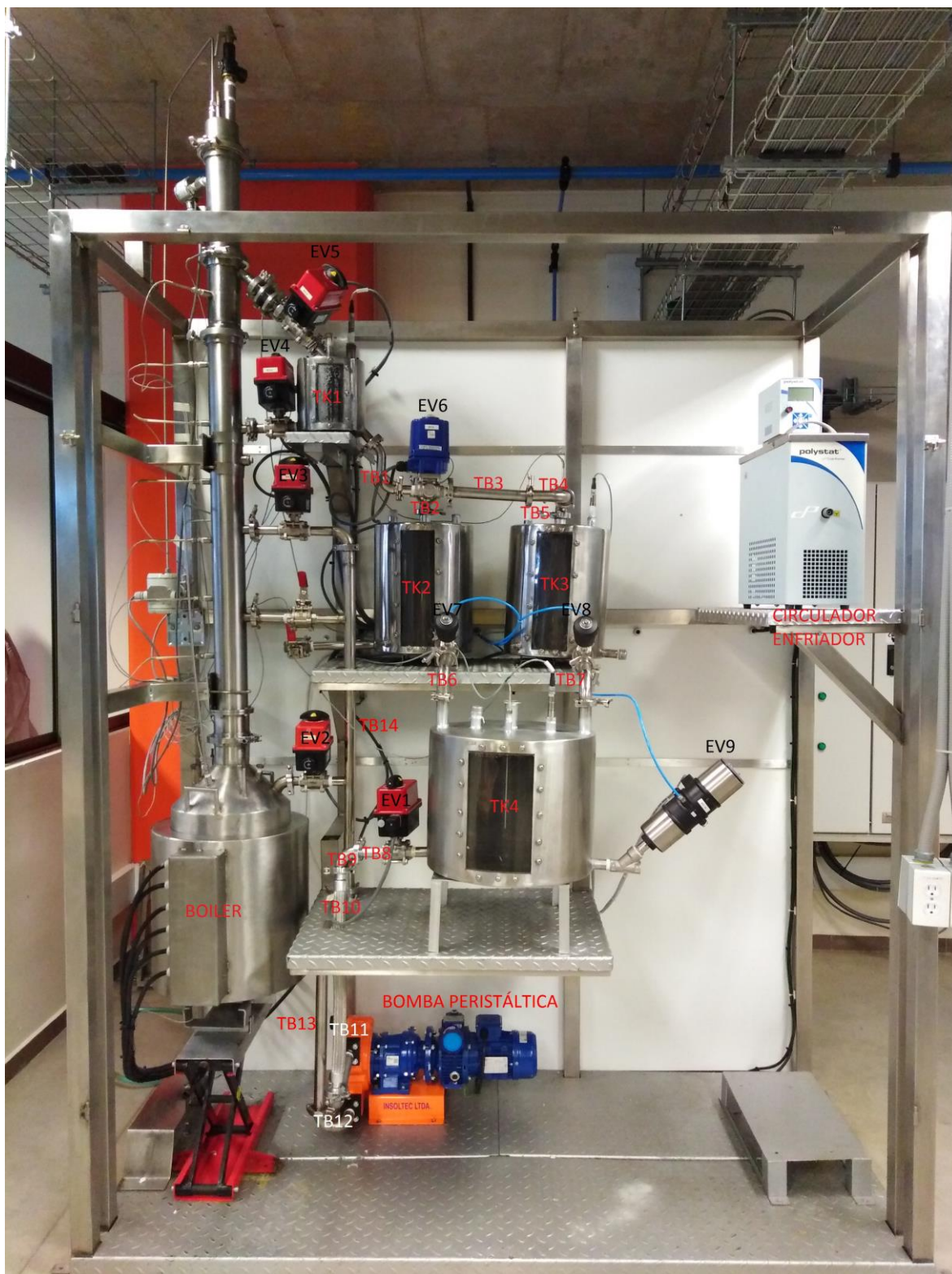
Figura 160. Numeración de elementos de la Planta Destiladora
