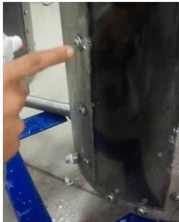
Figura 23. Fuga hermética, prueba neumática
