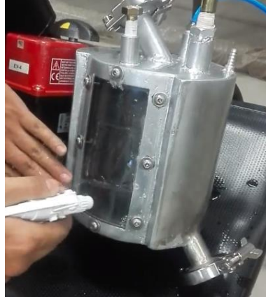
Figura 24. Tanque uno, prueba neumática
