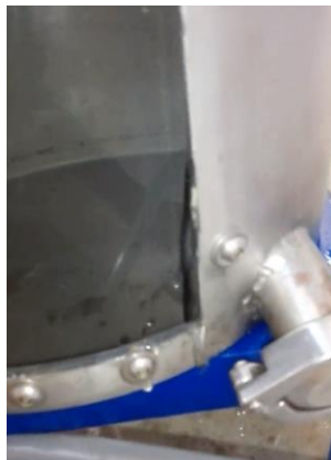
Figura 15. Fuga hermética tanque dos
