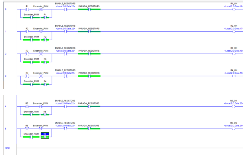
Figura 147. Acción de encendido del PWM en las resistencias
