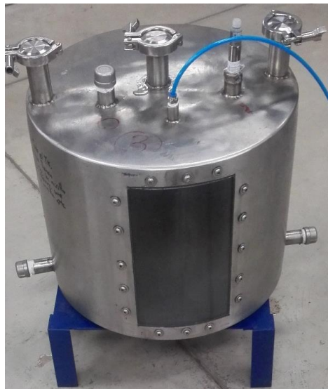
Figura 16. Tanque cuatro puesto a la prueba neumática
