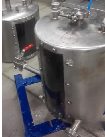
Figura 22. Tanque dos, prueba neumática
