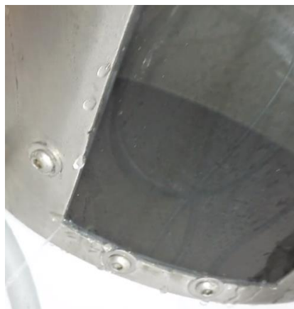
Figura 13. Fuga hermética tanque tres
