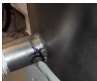
Figura 7. Porosidad uno del tanque cuatro.
