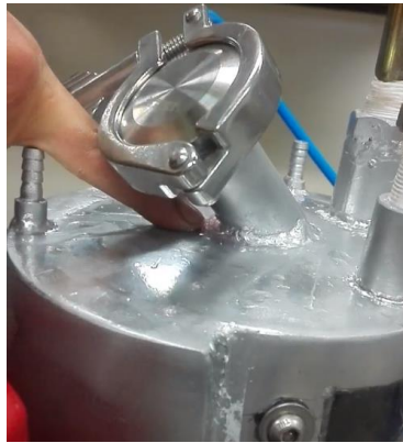
Figura 25. Fuga hermeticidad, prueba neumática
