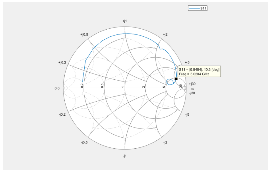
Figura. 14 Grafica de la carta de Smith para la frecuencia de 5GHz
