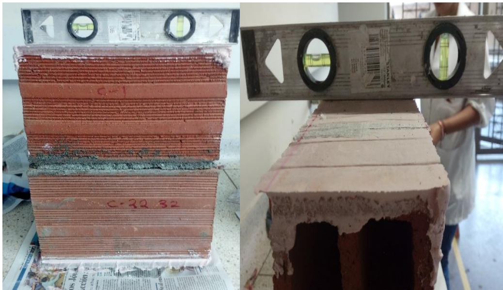
Ilustración 29. Revisión nivelación muretes
