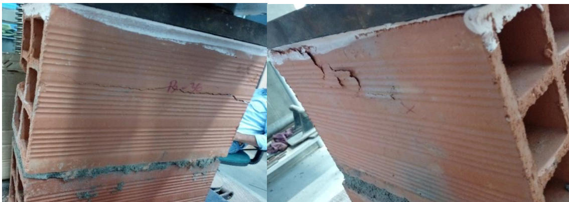
Ilustración 34. Fallas en los muretes.
