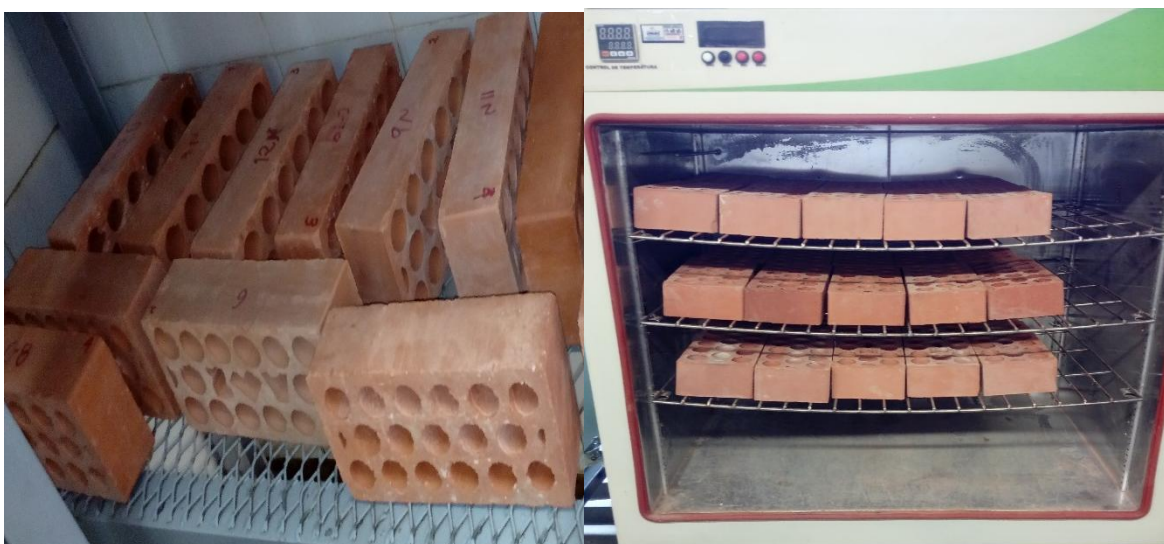
Ilustración 20. Secado de unidades en el cuarto de secado y en el horno
