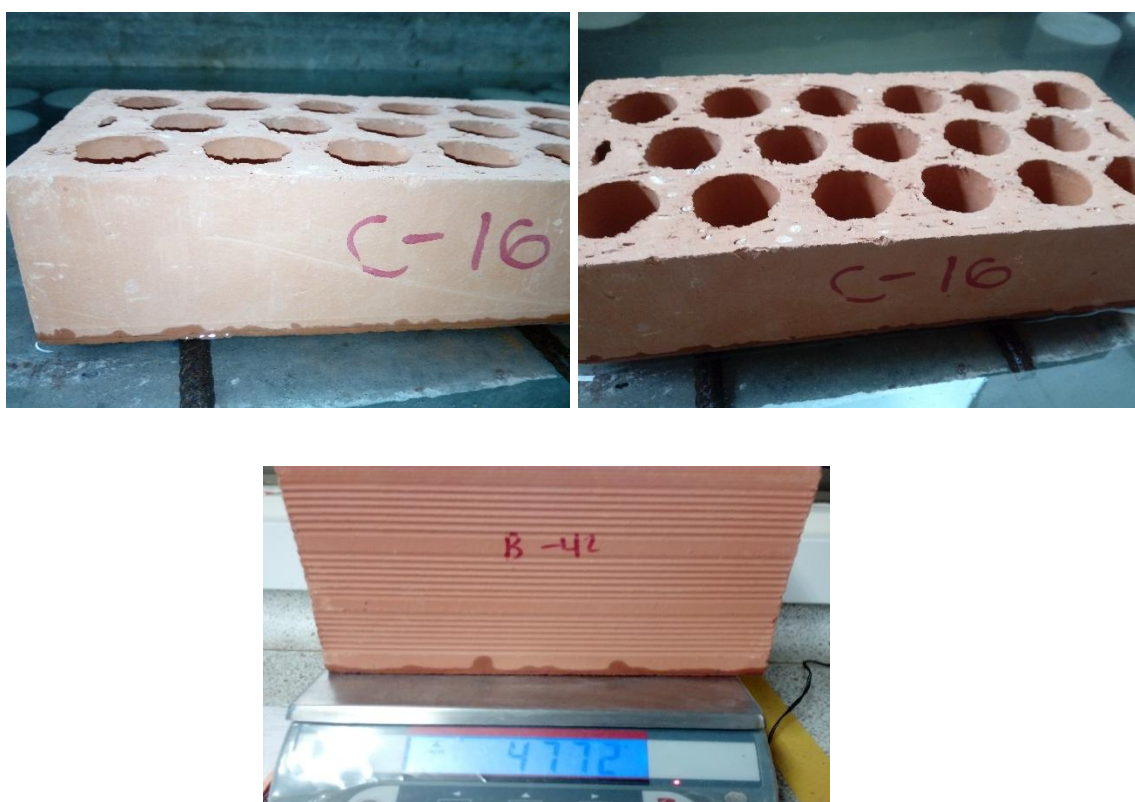
Ilustración 14. Verificación área en contacto con el agua y pesaje de las unidades
