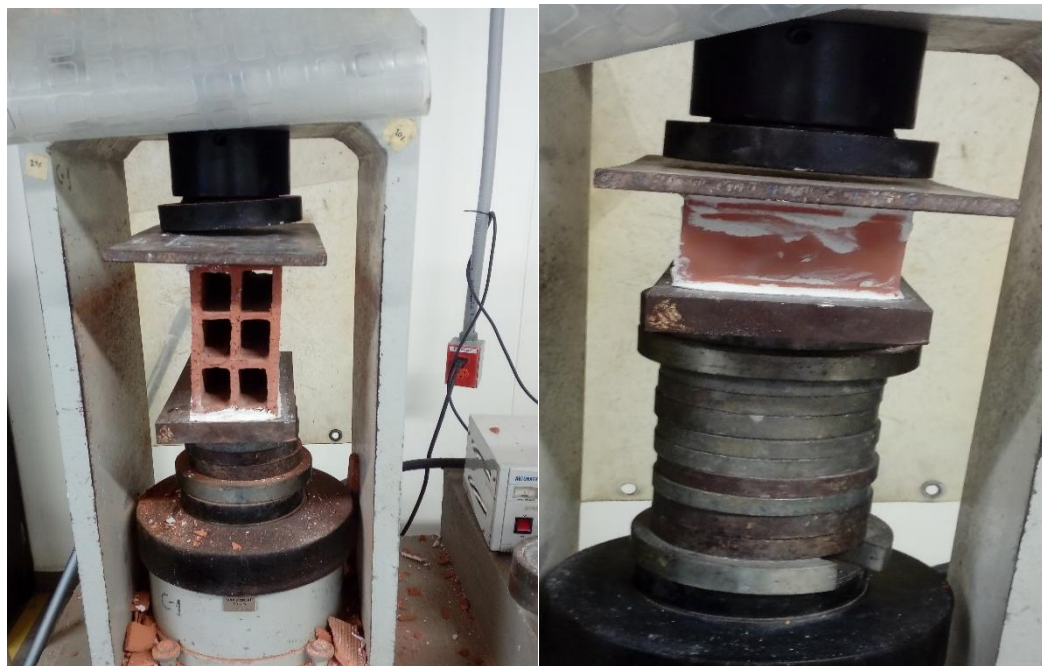
Ilustración 32. Ubicación de la unidad en la máquina de compresión
