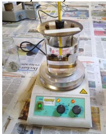
Figura 16: Montaje ensayo de ablandamiento
