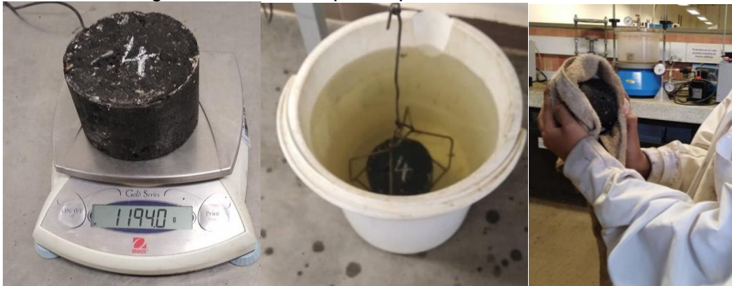
Figura 28: Toma de pesos para cálculo de densidad Bulk
