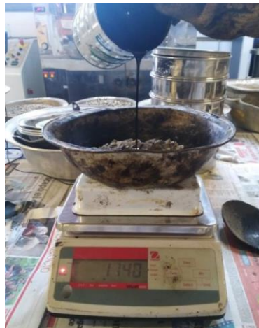
Figura 21: Vertimiento del asfalto en el agregado
