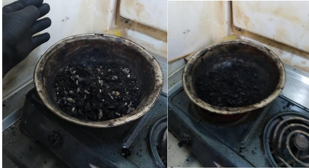
Figura 22: Mezcla del asfalto con el agregado
