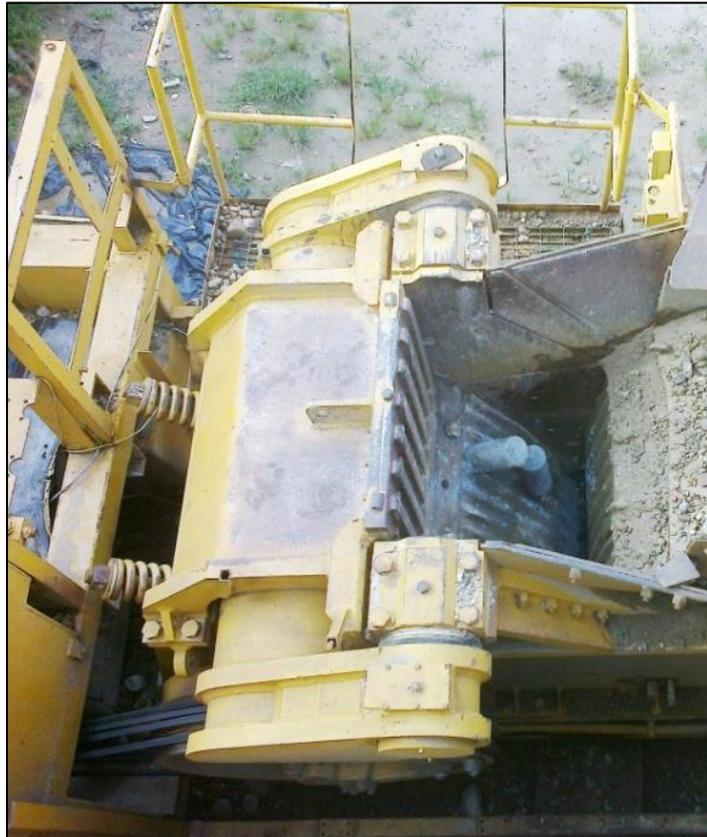
**Figura 5. Trituración del material reciclado.**
