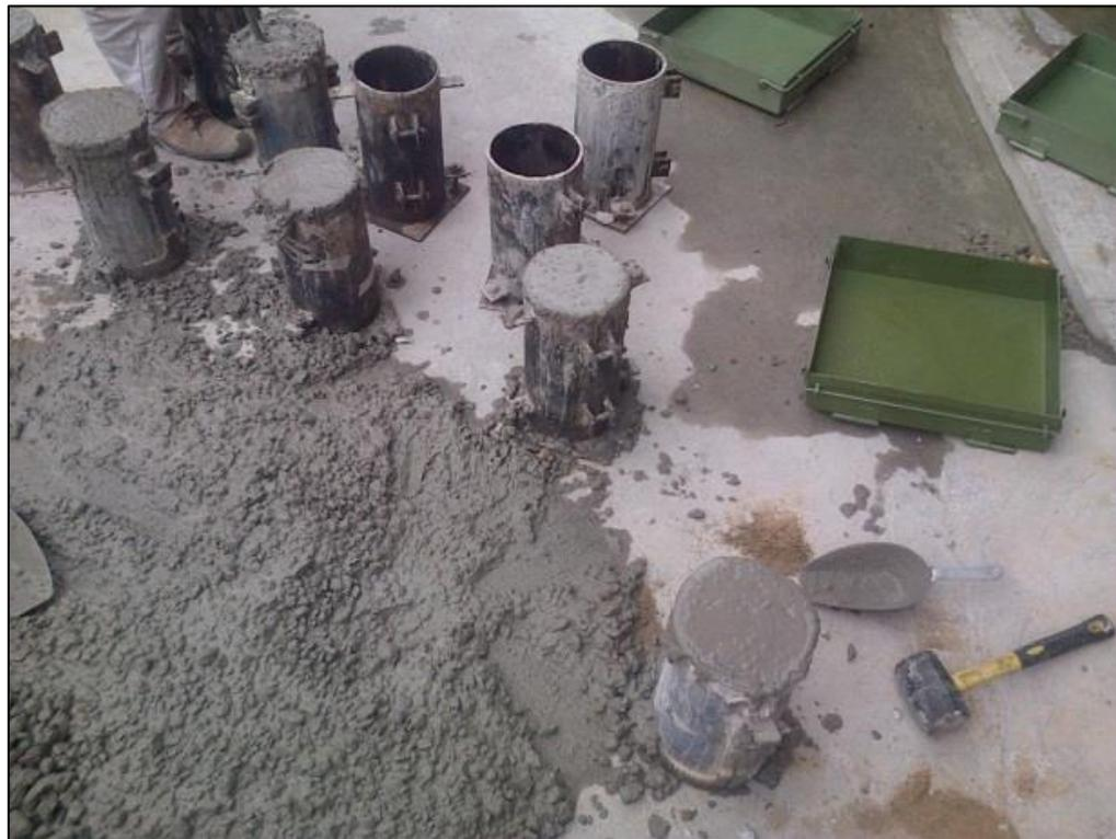
**Figura 20. Elaboración de cilindros y losetas con concreto reciclado**
