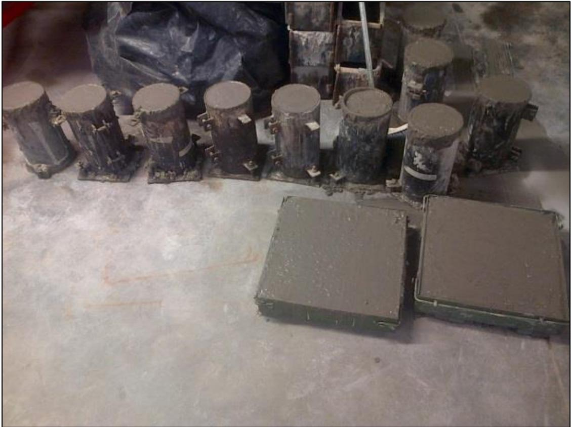
**Figura 22. Fraguado de cilindros y losetas prefabricadas.**
