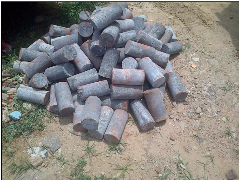
**Figura 4. Material reciclado y utilizado como agregado.**
