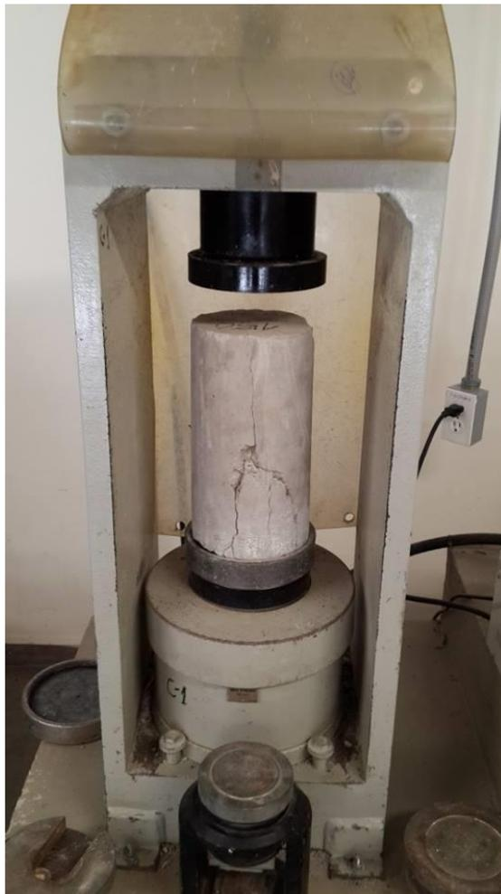
**Figura 23. Ensayo a compresión.**
