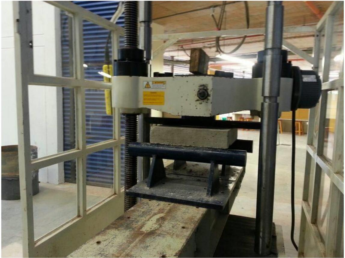
**Figura 25. Ensayo de flexión.**
