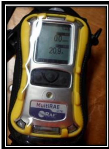
Figura 3: 'MultiRAE Meter' mostrando la medición de cloro y oxígeno atmosférico en un día común dentro de la cámara de distribución (Fuente: el autor)
