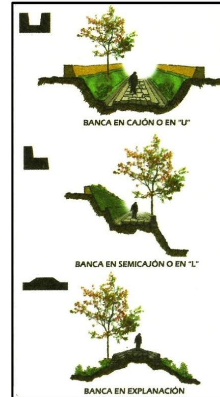
Imagen 19: Tipos de conformación de banca.<sup>61</sup>
