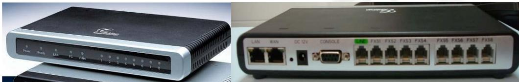
Figura 3. (a) Gateway GXW4008; (b) Vista posterior del Gateway GXW4008.
