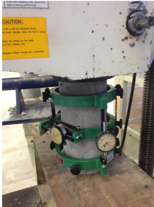
**Figura 20. Ensayo de Módulo de Elasticidad sobre Cilindros de Concreto.**
