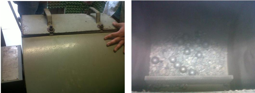
**Figura 9. Ensayo Máquina de los Ángeles Agregado Grueso.**
