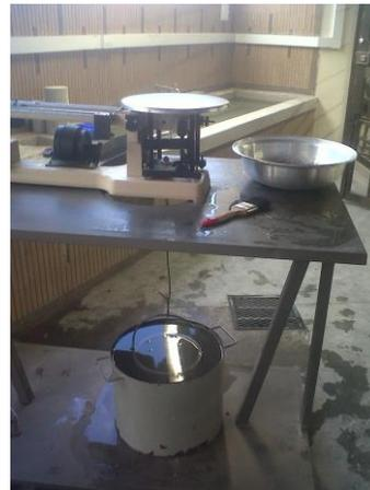
**Figura 4. Peso Específico y Absorción Agregado Grueso.**
