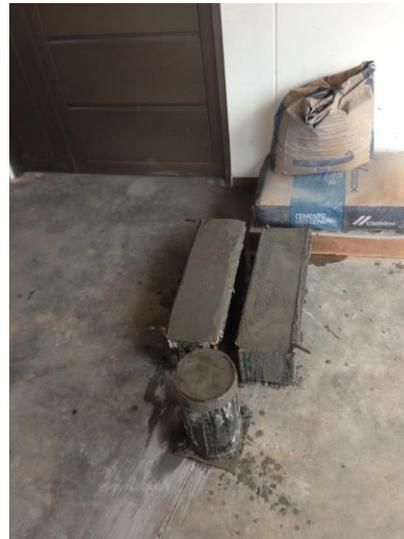
**Figura 15. Formaletas engrasadas y Viga Reforzada, no reforzada y cilindro de concreto para realizar módulo de elasticidad.**
