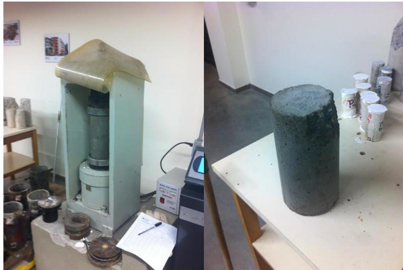
**Figura 2. Prueba de Compresión de Cilindros de Concreto Preliminares.**
