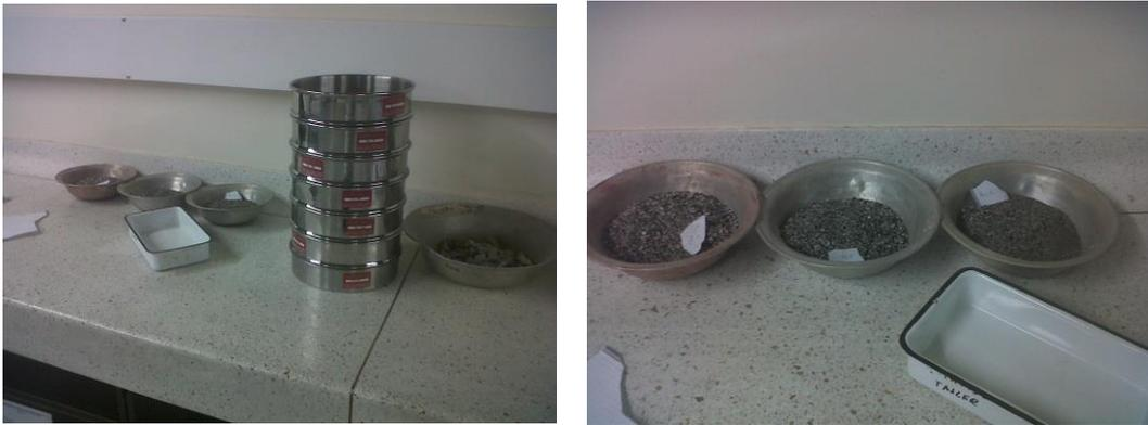
**Figura 6. Granulometría Agregado Grueso y Fino.**
