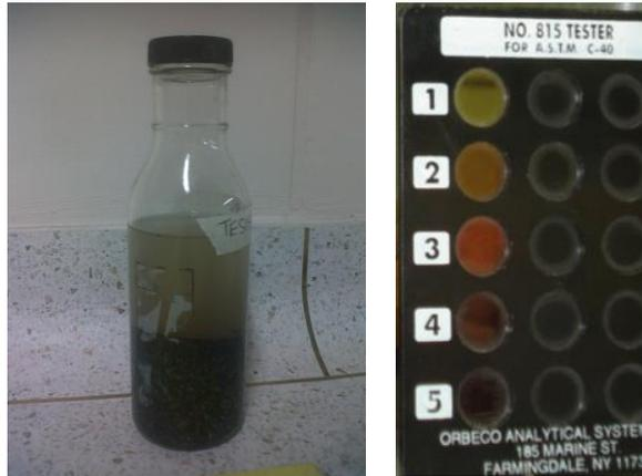
**Figura 10. Colorimetría Agregado Fino.**
