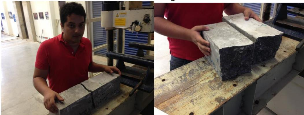
**Figura 17. Prueba de Viga No Reforzada.**
