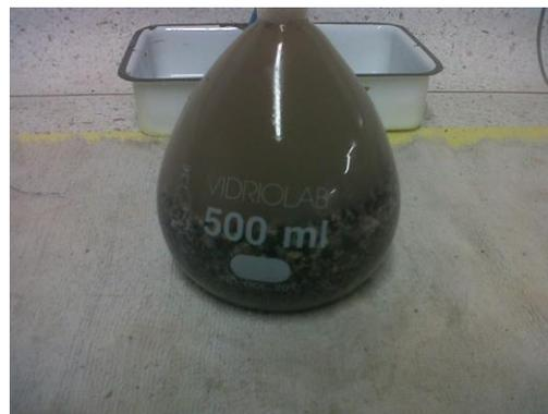
**Figura 5. Peso Específico y Absorción Agregado Fino.**
