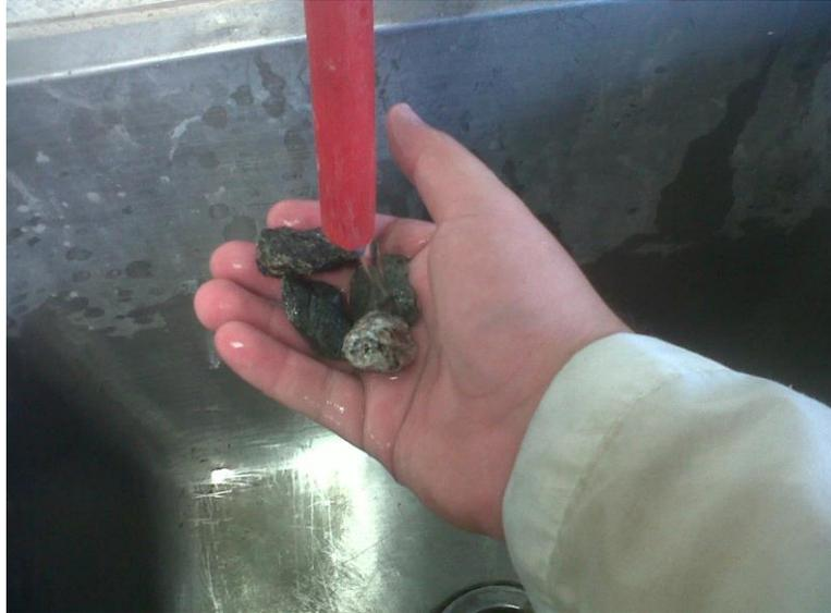
**Figura 8. Ensayo de Caras Fracturadas Agregado Grueso.**
