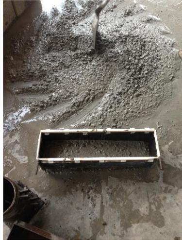
**Figura 14. Vigas Reforzadas y No Reforzadas de la Prueba Piloto.**
