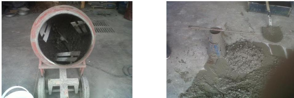
**Figura 12. Mezcla de Concreto en Laboratorio y Asentamiento.**
