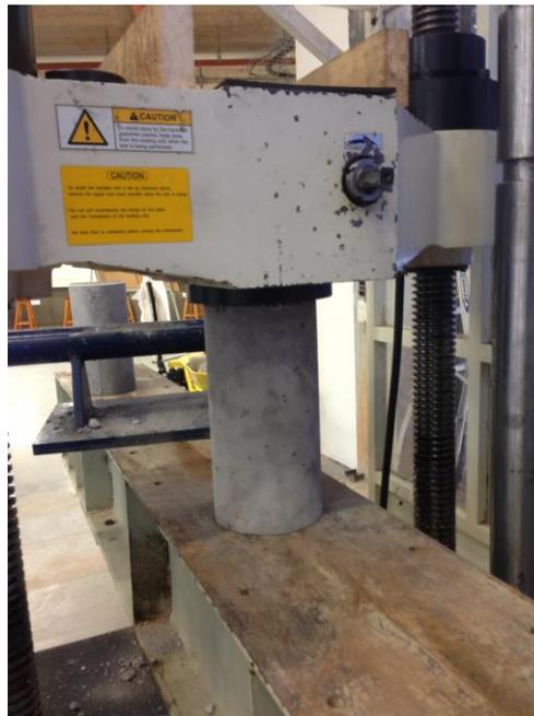
**Figura 19. Ensayo de Compresión de Cilindros de Concreto.**
