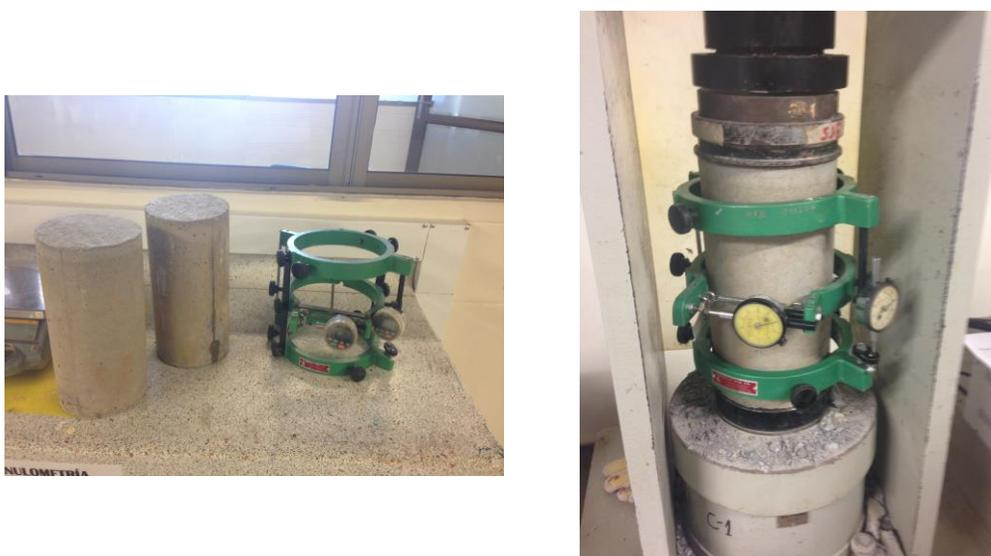
**Figura 3. Prueba de Módulo de Elasticidad en Cilindros Preliminares.**
