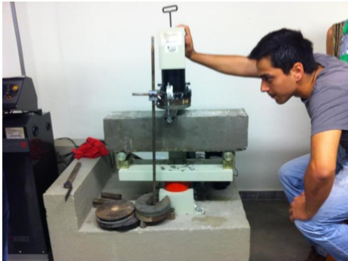
**Figura 1. Ensayo de Flexión en Vigas Preliminares.**
