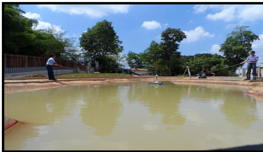
FOTOGRAFIA 138. Realizando ensayo de Batimetría
