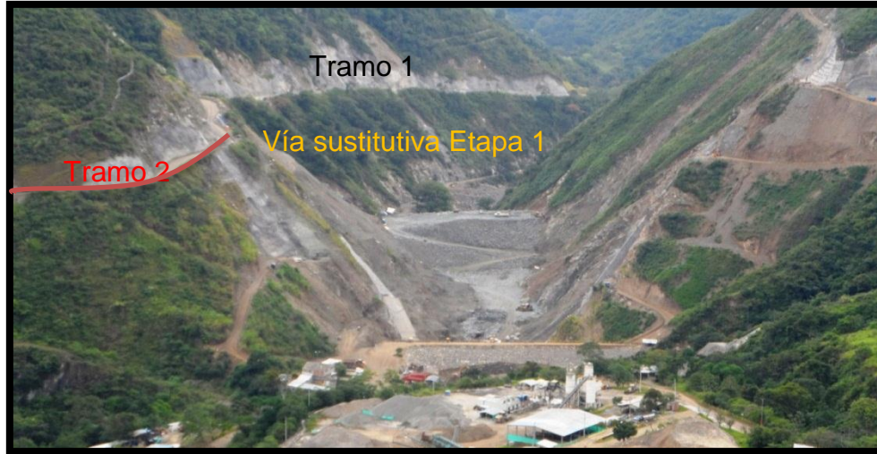
FOTOGRAFIA 57. Esquema de la vía sustitutiva etapa 1 tramo 1-2
