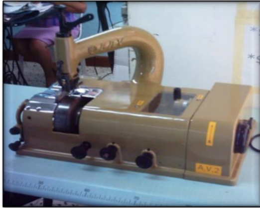
Máquina desbastadora - Fortuna Werker GMBH serie 70149
