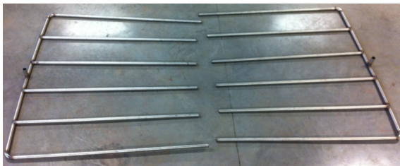
Figura 6.11: Fotografía de la tubería fabricada
