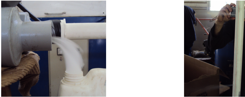
Figura 5.8: Fotografías de visualización de flujo a través de humo marcador
