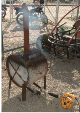
Figura 5.9: Fotografía del primer arreglo con un soplador manual
