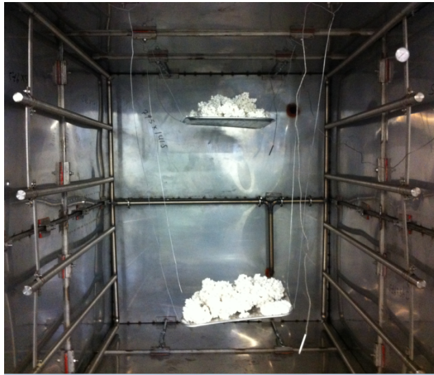
Figura 7.8: Fotografía de ubicación de las bandejas con látex dentro de la cabina de secado.
