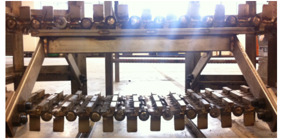
Figura 6.8: Fotografía muestra detalle de las guías de la banda transportadora.
