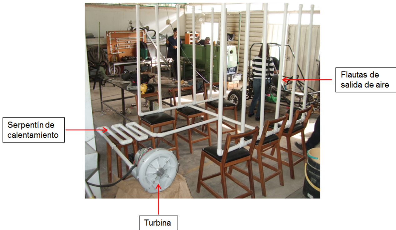
Figura 5.7: Fotografía del montaje realizado para simular la tubería y la turbina.
