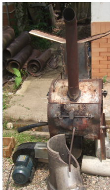
Figura 5.11: Fotografía del tercer arreglo con el soplador industrial
