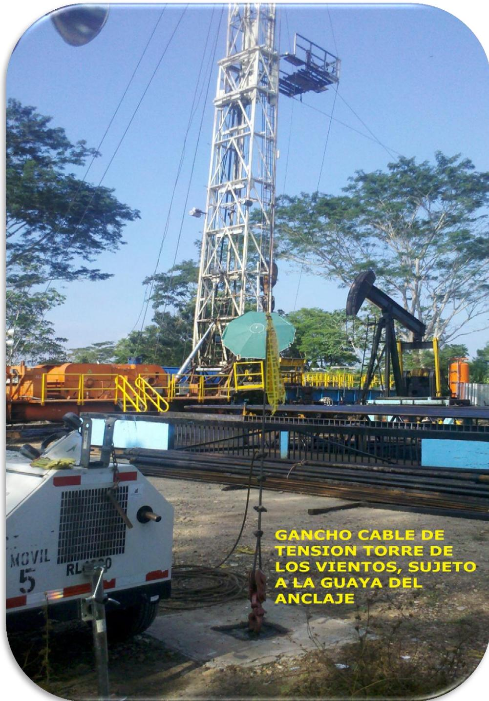
En los pozos petroleros, los equipos de Workover tienen por objeto aumentar la producción a través de la extracción y limpieza de varillas que se encuentran a 3000 pies de profundidad o reparar pozos existente
