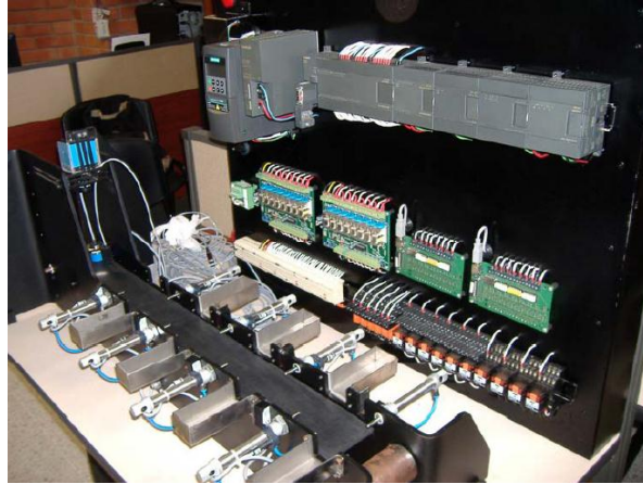
Figura 5. Prototipo calle de selección y panel de control 12
