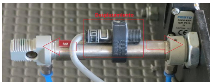
Figura 83. Desplazamiento del sensor magnético
