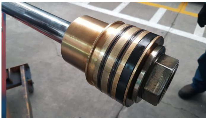
Ilustración 4: mantenimiento Actuador hidráulico
