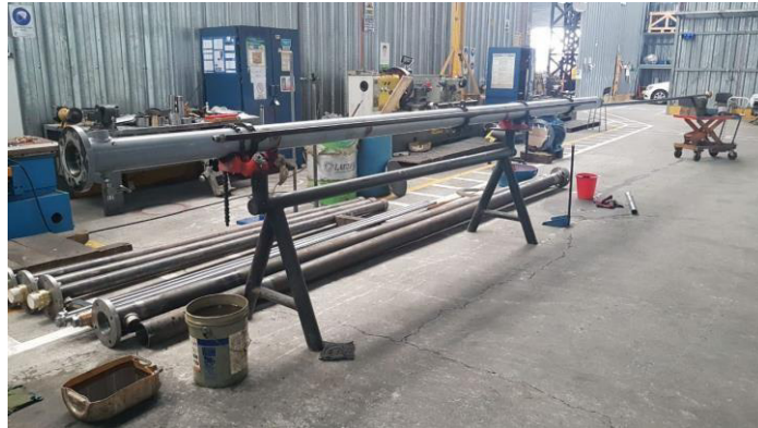
Ilustración 3: mantenimiento Actuador hidráulico
