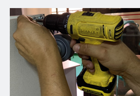
Ensamble de las 4 rodachinas en las esquinas
