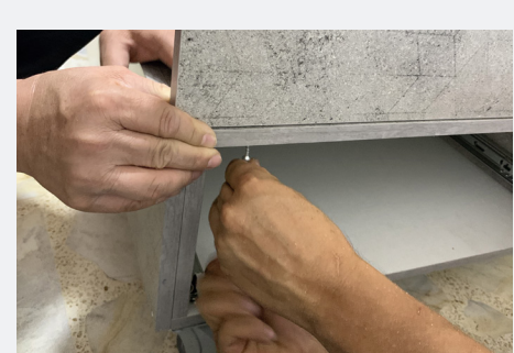
Ensamble de la pared trasera por dentro de las bases centrales
