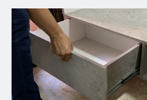
Ensamblar los cajones en las bases centrales
