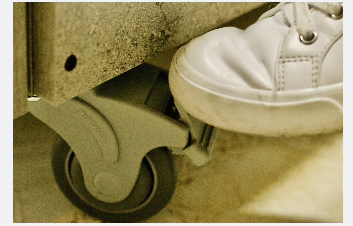
Para girar el sistema, se debe quitar el seguro de las rodachinas con ayuda de los pies
