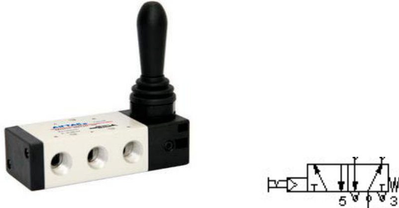
Figura 14. Válvula 5/2 Manual [4]
