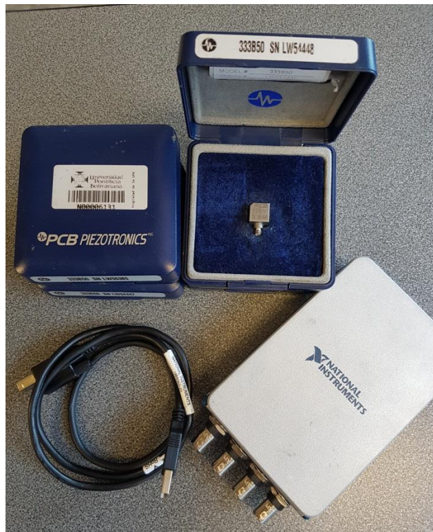
Figura 9. Equipo de adquisición del laboratorio de estructuras UPB
