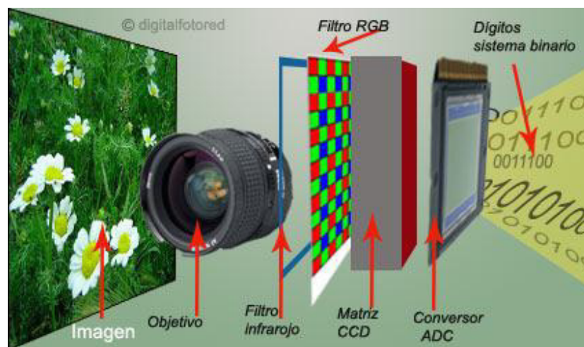
Figura 2. Formación de la imagen digital (Digitalfotored, 2005a).
