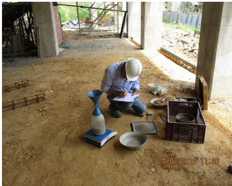
*Figura 23.* Ensayo densidad unitaria del suelo por el método del cono de arena edificio 1 – Colegio Puerto Madero.
