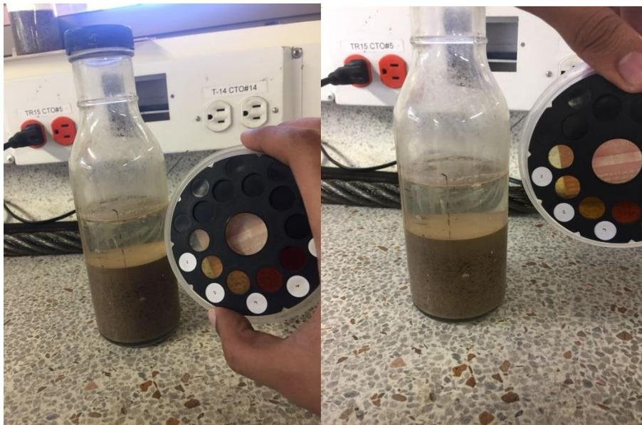
*Figura 12 Ensayo contenido de materia orgánica*
