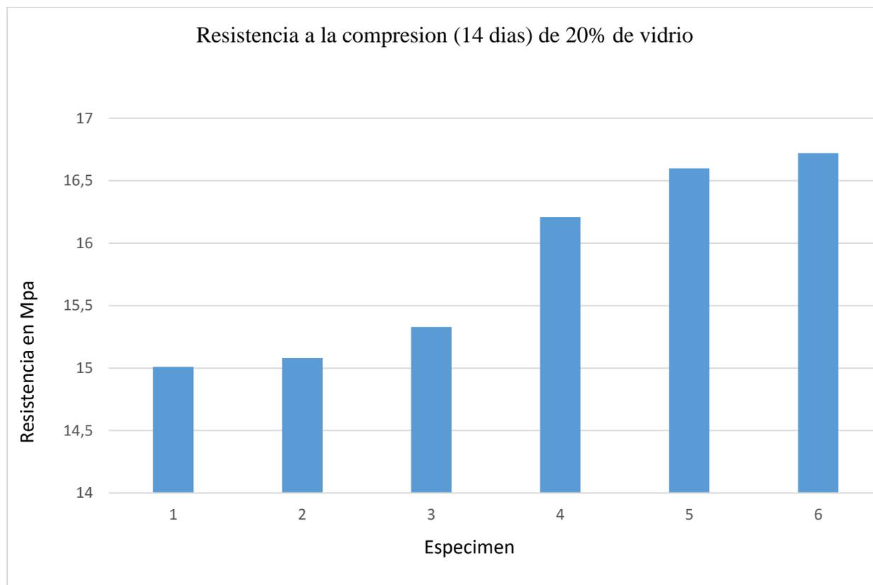
*Figura 20 Resistencia a la compresión de 20% de vidrio a los 14 días de curado*
