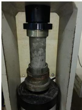
*Figura 6 concreto sometido al ensayo de compresión*
