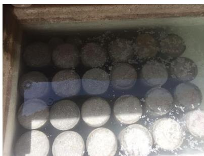
*Figura 5 Curado de especímenes de concreto*
