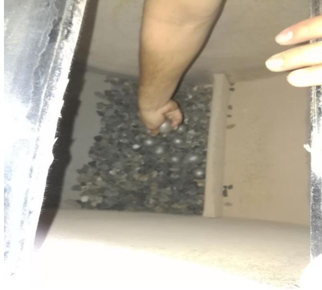
Imagen 14 Muestra El Ensayo De Maquina De Los Ángeles
