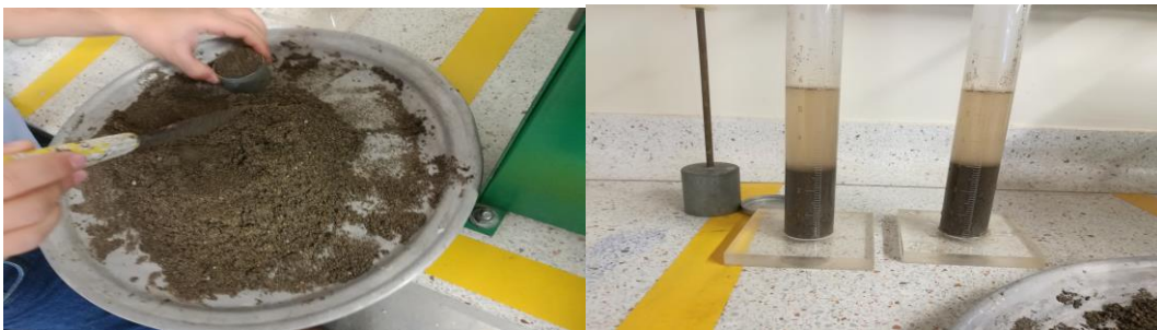
Imagen 7 Muestra Y Ejecución Ensayo Equivalente De Arena Fuente: El autor
