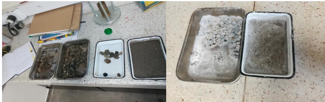
Imagen 10 Muestras Ensayo Solidez Con Sulfatos
