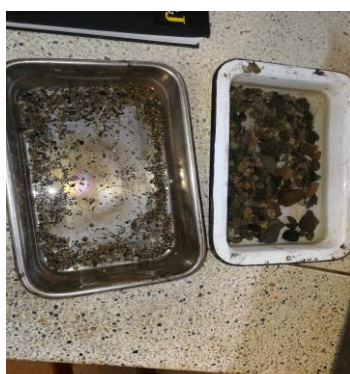
Imagen 6 Muestras Ensayo Partículas Deleznable Y Contenido De Terrones De Arcilla
