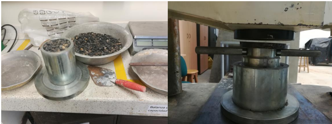
Imagen 12 Muestra Y Ejecución Ensayo 10% De Los Finos
