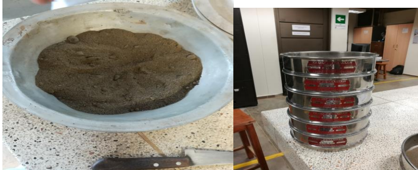
Imagen 3 Muestras Ensayo Granulometría
