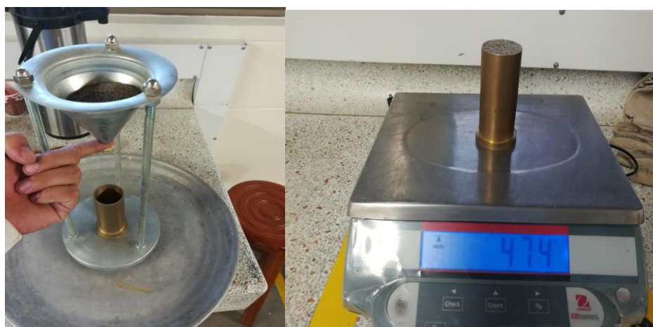
Imagen 11 Ejecución Ensayo Angularidad De La Fracción Fina
