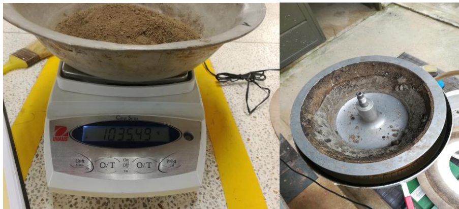
Imagen 4 Muestras Ensayo Porcentaje De Asfalto
