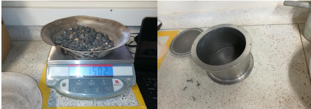
Imagen 13 Muestra Para Ensayo Micro- Deval
