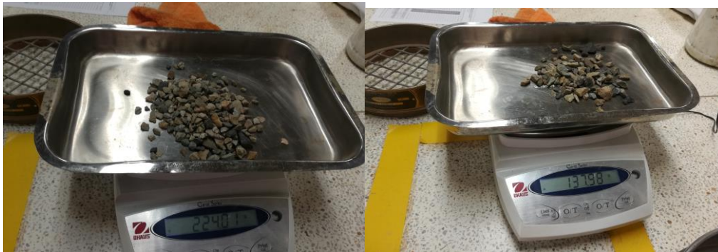
Imagen 9 Muestras Partículas Fracturadas
