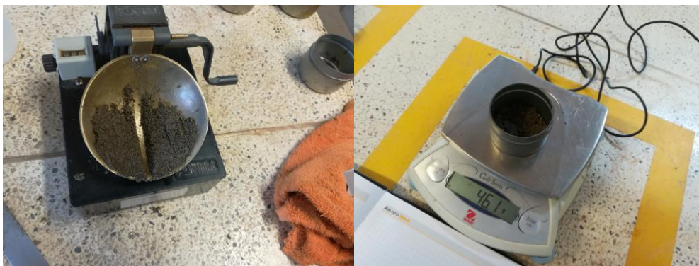
Imagen 5 Ejecución y muestra ensayo limite líquido y limite plástico
