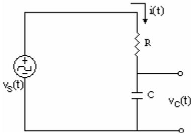
donde,  $v_s(t)$  (señal de entrada) y  $v_c(t)$  (señal de salida).
