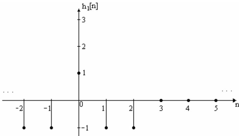
Se necesitan tres respuestas, debido a que  $x[n]$  solo tiene tres valores diferentes de cero. De acuerdo a la propiedad de "linealidad", la respuesta de S1 a  $x[n]$  (debido a que  $x[n]$  es una suma de impulsos) es la combinación lineal de las respuestas básicas. Se toma  $x[n]$ ,
