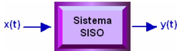
Estos sistemas pueden ser modelados usando una ecuación diferencial que muestra la relación entrada - salida.
