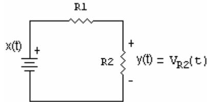
La salida se puede escribir  $y(t) = \frac{R_2}{R_1 + R_2} x(t)$  si  $R_1 = R_2 = R \Rightarrow y(t) = \frac{1}{2} x(t)$ .
