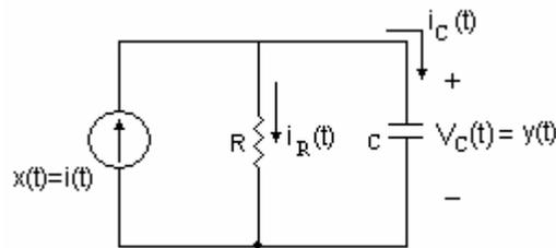
donde,  $i(t)$  (señal de entrada) y  $v_c(t)$  (señal de salida).
