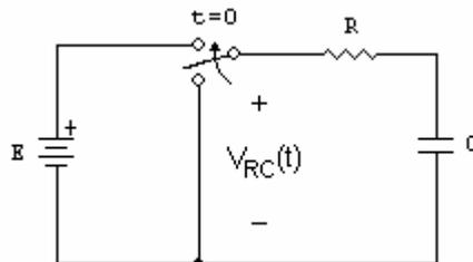
$$V_{RC}(t) = Eu(t) \text{ voltaje aplicado}$$
