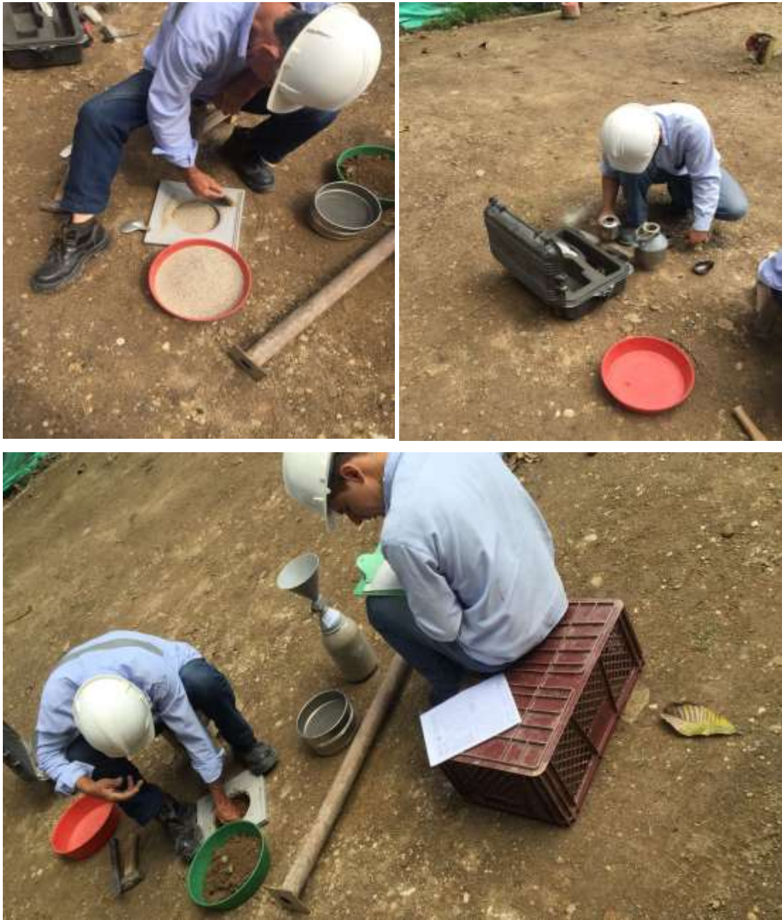
Ilustración 28. Memorias fotográficas proceso de ensayo de compactación Fuente: Autor
