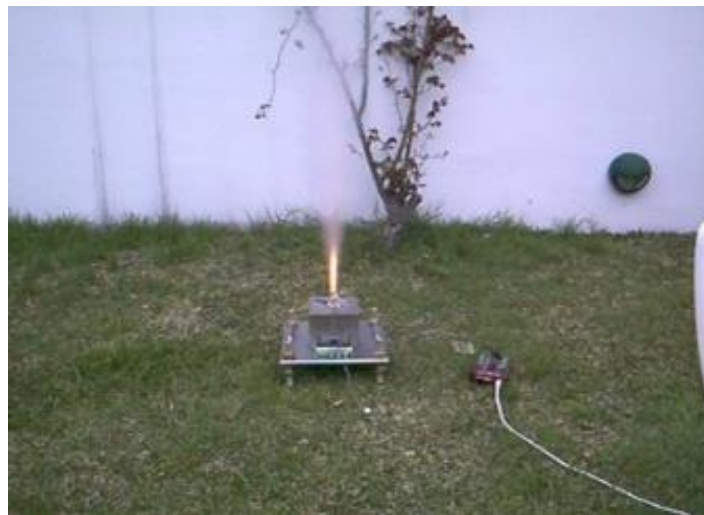
Figura 18 Banco de pruebas con sistema de medición de celda de carga [6]
