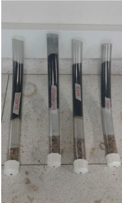
Figura 8. Filtros de carbón activado granular. Orden de izquierda a derecha: Blanco (antracita), Bituminoso, Nuez, Cáscara de coco.
