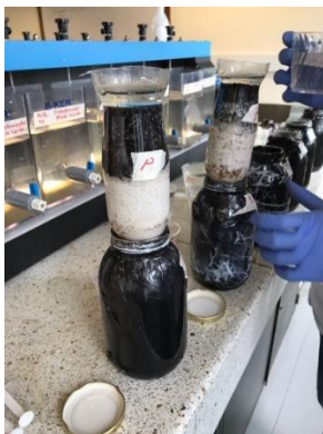
Figura 7. Composición de los filtros convencionales a escala laboratorio Fuente: Autor
