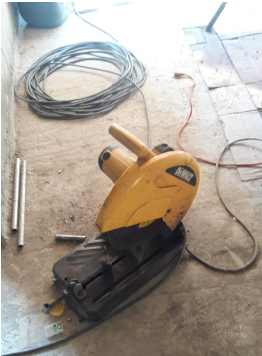
Ilustración 14. Corte de la tubería con tronzadora industrial
