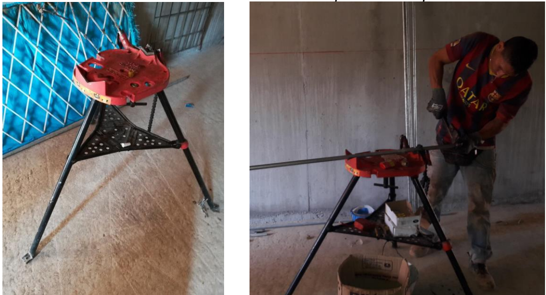
Ilustración 16. Ensamblado de los accesorios en prensa de trípode
