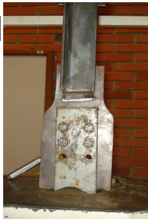
Foto N° 17. Ruptura de ct-3/16
