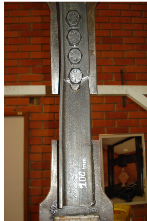
Foto N° 15. Ruptura de ct-100
