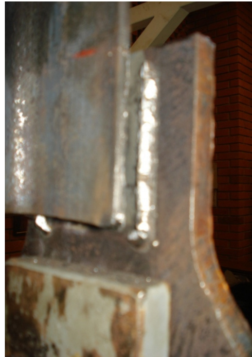
Foto N° 13. Ruptura de ct-75
