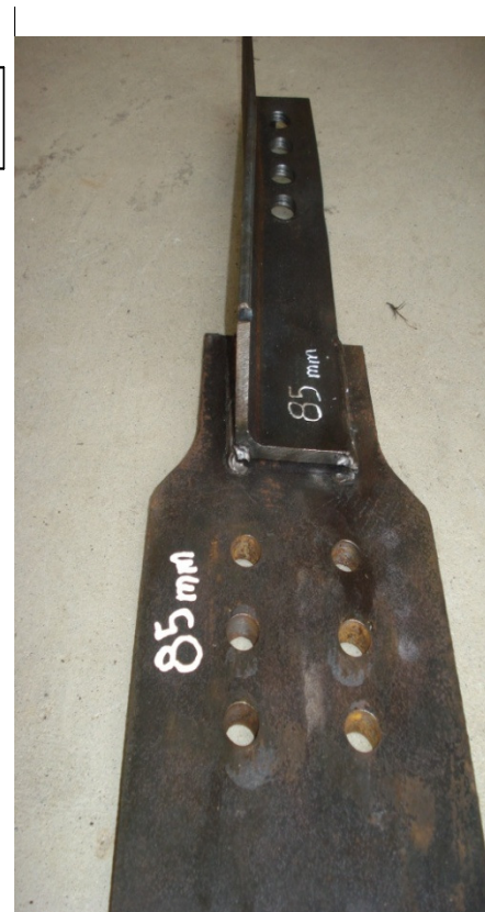
Foto N° 14. Ruptura de ct-85
