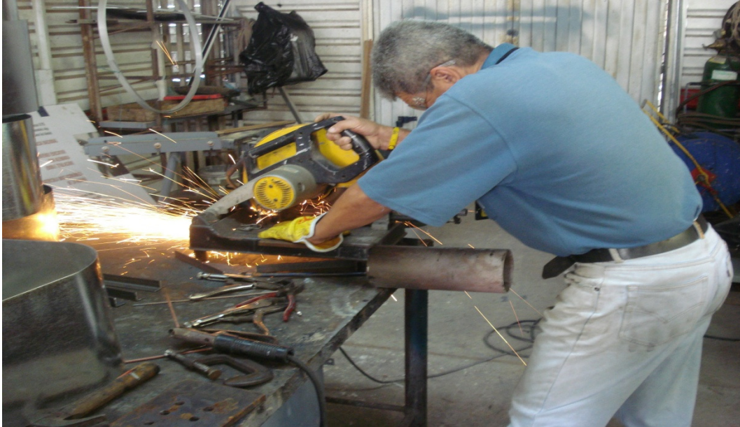
Foto N° 4. Corte de las platinas metálicas
