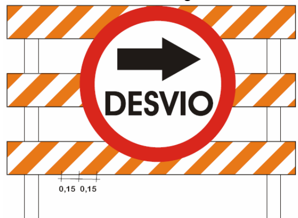
Barricada de seguridad
