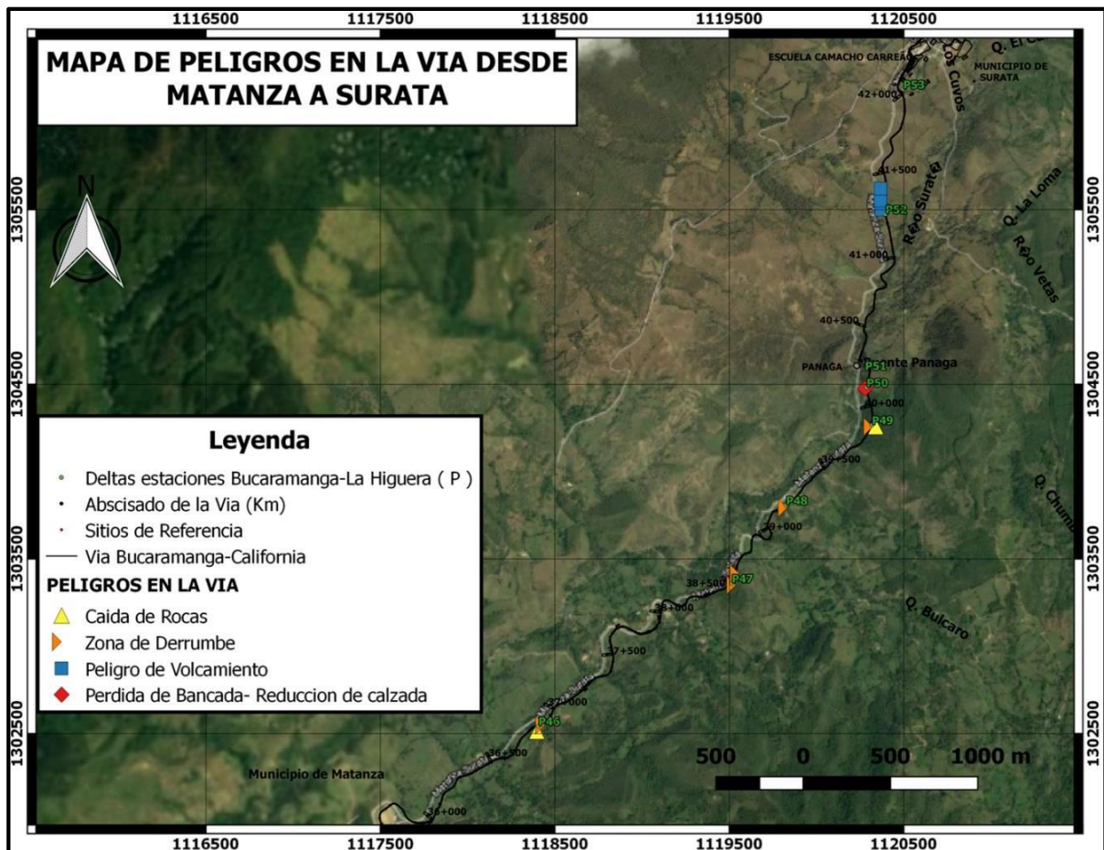
Ilustración 13: Mapa de peligros por sectores en la vía de Matanza - Surata
