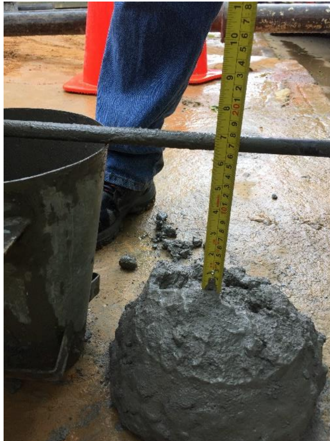
Imagen 23 Prueba de slump ( Concreto ciclópeos)
