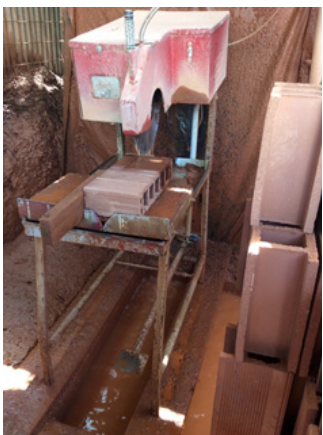
Ilustración 42. Cortadora: fuente generadora
