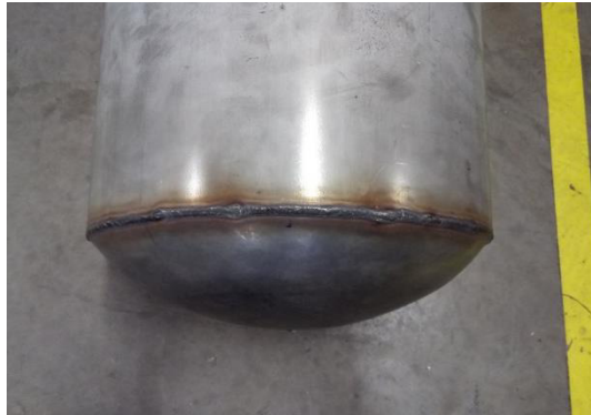
Figura 21. Cordón de soldadura Tapa- Tanque interno.
