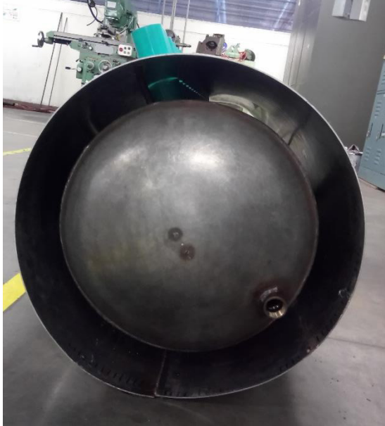
Figura 24. Centrado de los tanques.
