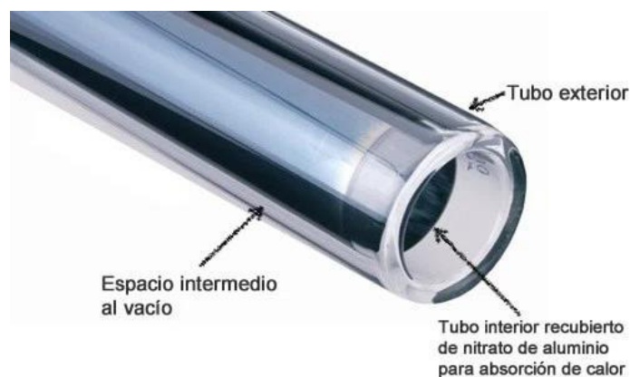
Figura 5. Tubo de vidrio al vacío
