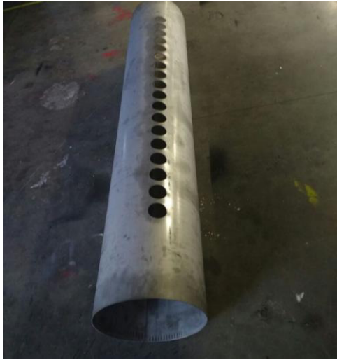
Figura 19. Troquelado y rolado de lámina del tanque interno.
