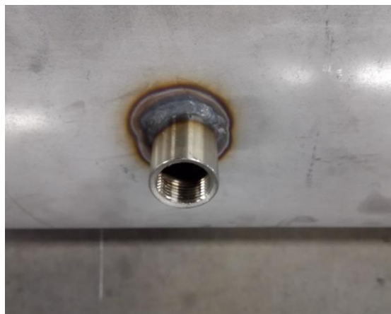
Figura 22. Entrada de agua.
