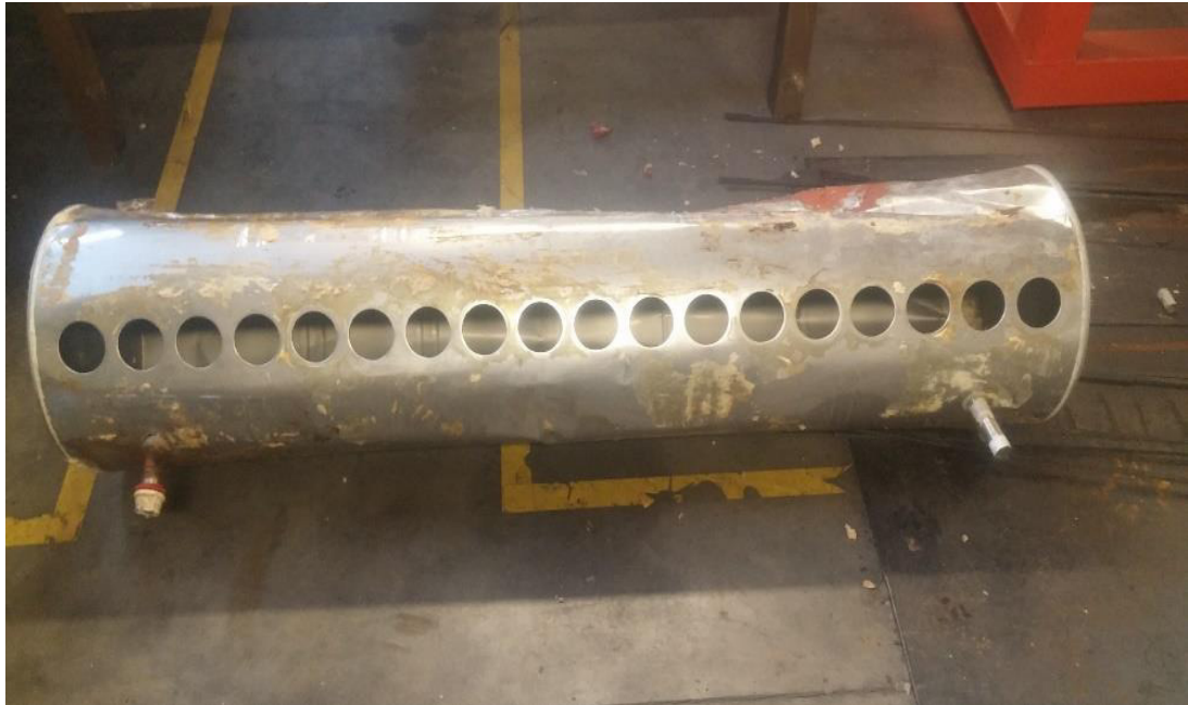
Figura 18. Tanque interno afectado
