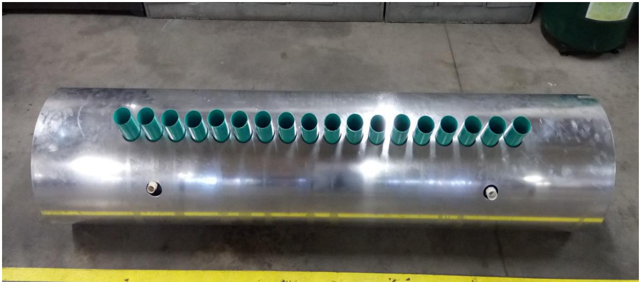
Figura 25. Colocación tubos de PVC para el centrado de los tanques.
