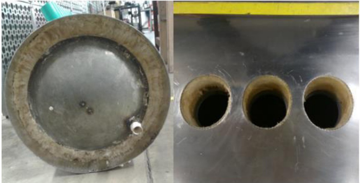
Figura 28. Retiro de excesos de Poliuretano.
