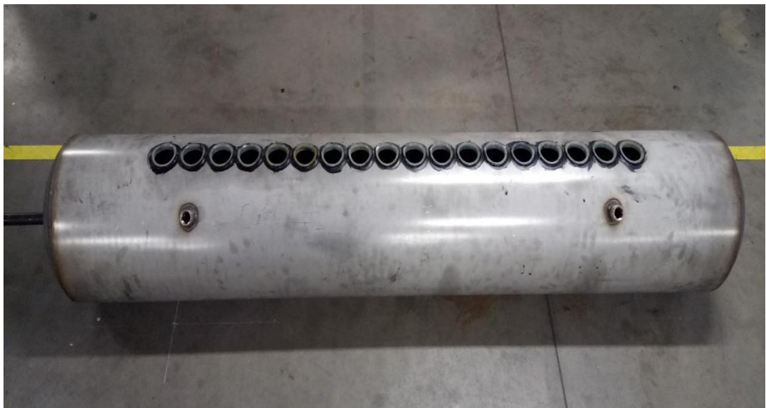
Figura 23. Instalación de los anillos de silicón.
