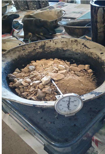
Figura 38-Toma de temperatura durante el proceso de pesado de los agregados según lo sugerido por el instituto del asfalto para el ensayo Marshall
