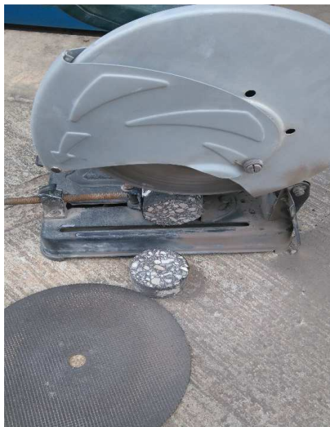
Figura 41-Corte de las probetas realizadas en el compactador giratorio
