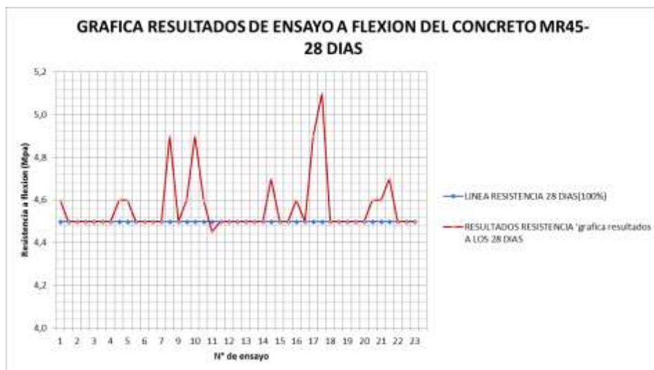
Figura 8. Grafica de resultados de ensayo flexión del concreto 28 días
