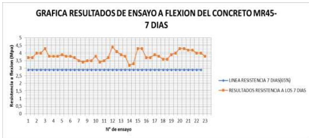
Figura 8. Grafica de resultados de ensayo flexión del concreto a los 7 días
