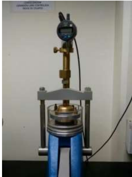
Figura 12. Cámara de consolidación con deformímetro digital.
