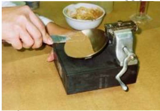
Figura 125 - 6. Colocación del suelo dentro de la cazuela
