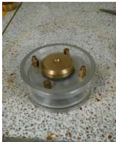
Figura 11. Cámara de consolidación armada
