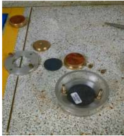
Figura 8. Cámara de consolidación desarmada.
