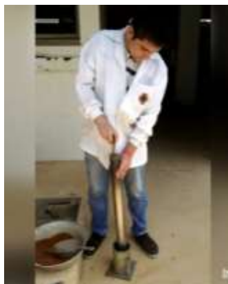
Figura 6. Ensayo de compactación
