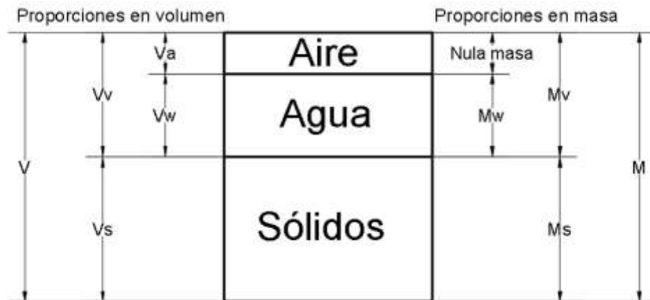
Figura 3. Representación esquemática de las fases de un elemento de suelo.
