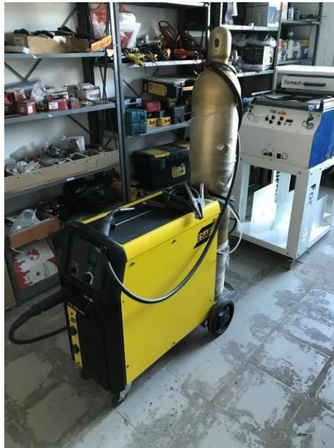
Figura 4. Equipo de soldadura Origo Mig C280 PRO. Fuente: Archivo del autor.
