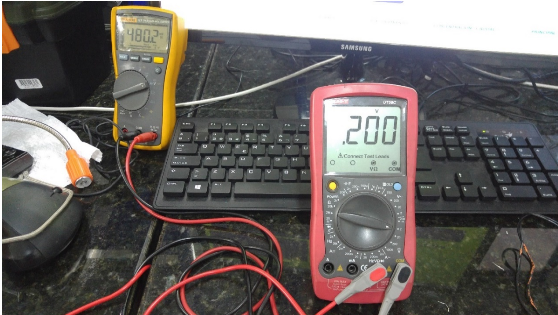
Figura 32. Multímetro a la derecha lectura de la diferencia del puente de Wheatstone y a la izquierda lectura después del amplificador de instrumentación.
