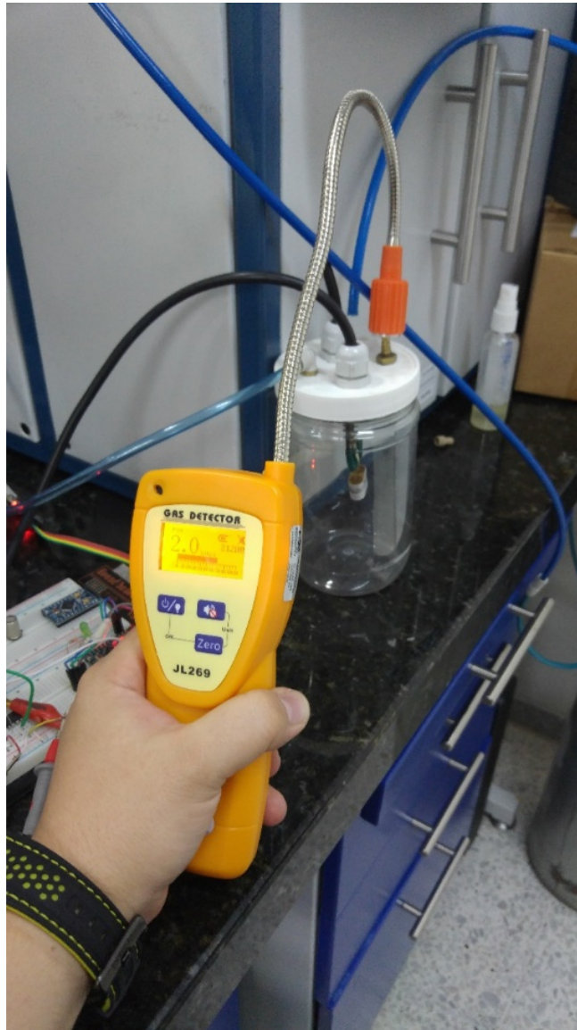
Figura 34. Utilizando un detector calibrado para corroborar el %mol de concentración de gas.
