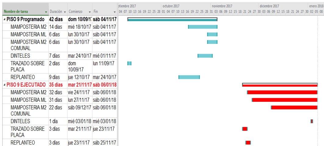
Figura 27: Programación y ejecución de mampostería piso 9.
